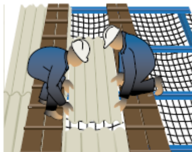
Fig. 32 – Rede de segurança utilizada para amparar os trabalhadores em caso de queda em altura
