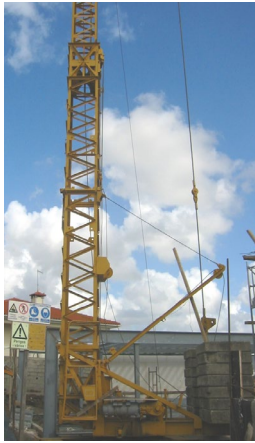
Fig. 45 - Limitador de binário numa grua auto-montante
