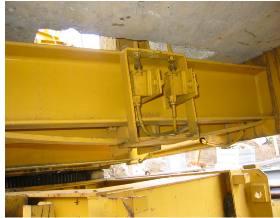
Fig. 45 - Limitador de binário numa grua auto-montante
