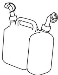
reservatório duplo de combustível e óleo (com sistema anti-derrame)
