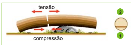
Forças de tensão no lado superior do tronco
