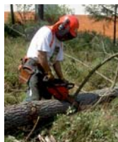
Posicionamento e postura durante o corte de ramos
