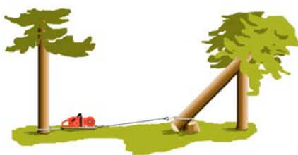
Utilização de equipamento de tração na libertação de árvores enganchadas
