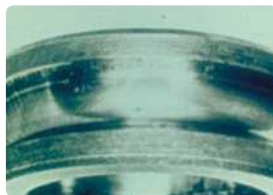
Estágio 2: Fadiga superficial e surgimento de pequenas trincas. Depois ocorre o microdescascamento.
