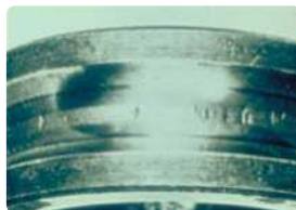
Estágio 3: Os elementos rolantes passam pelas partículas metálicas; acontece o descascamento real da superfície.
