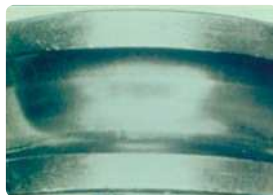
Estágio 1: Polimento ou ondulação desenvolve-se na superfície.
