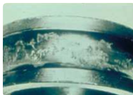
Estágio 4: Se operar por muito tempo, toda a pista é descascada; os danos iniciais já não poderão ser observados.
